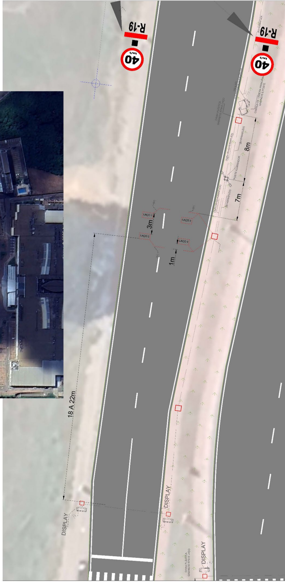
DETALHE A - TRECHO PA-275 KM 61+900 - CAPTURA DE IMAGEM PELA TRASEIRA ESCALA 1:200
