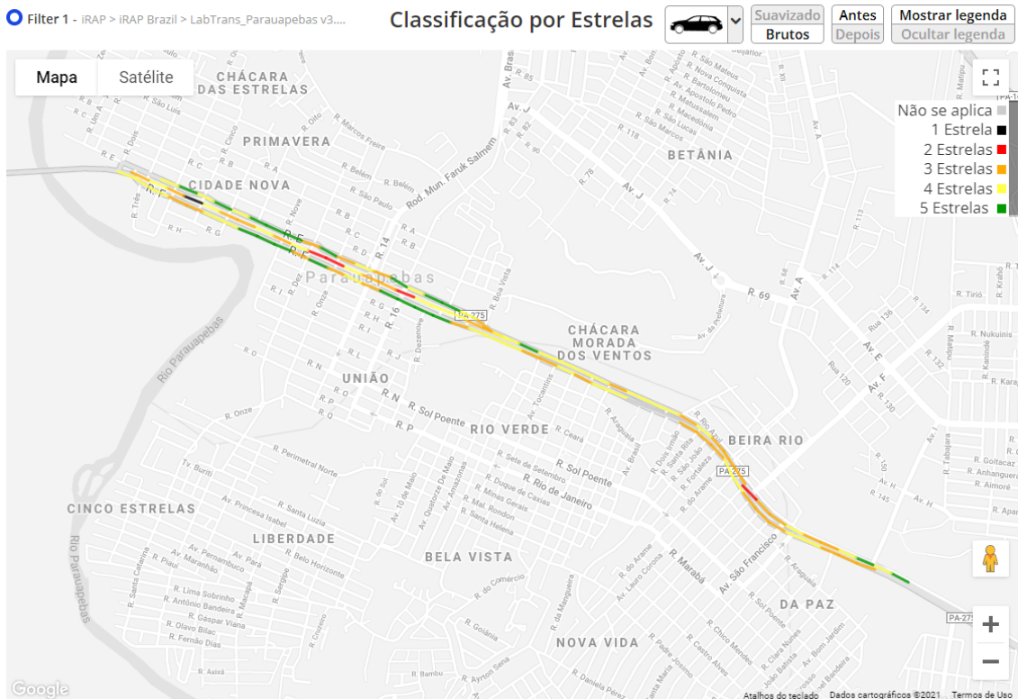
Figura 193 – Mapa da Classificação por Estrelas do Corredor de Transportes para ocupantes de veículos
