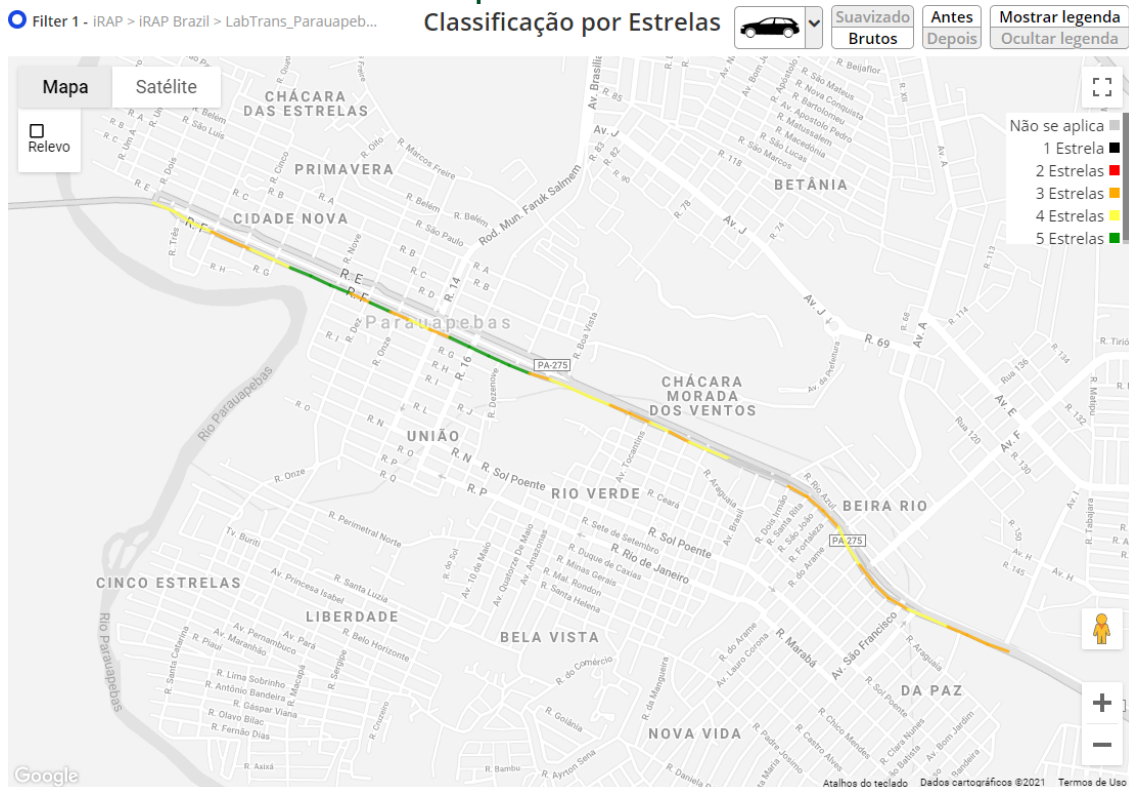
Figura 197 – Mapa da Classificação por Estrelas da Rua F e da Avenida Liberdade para ocupantes de veículos
